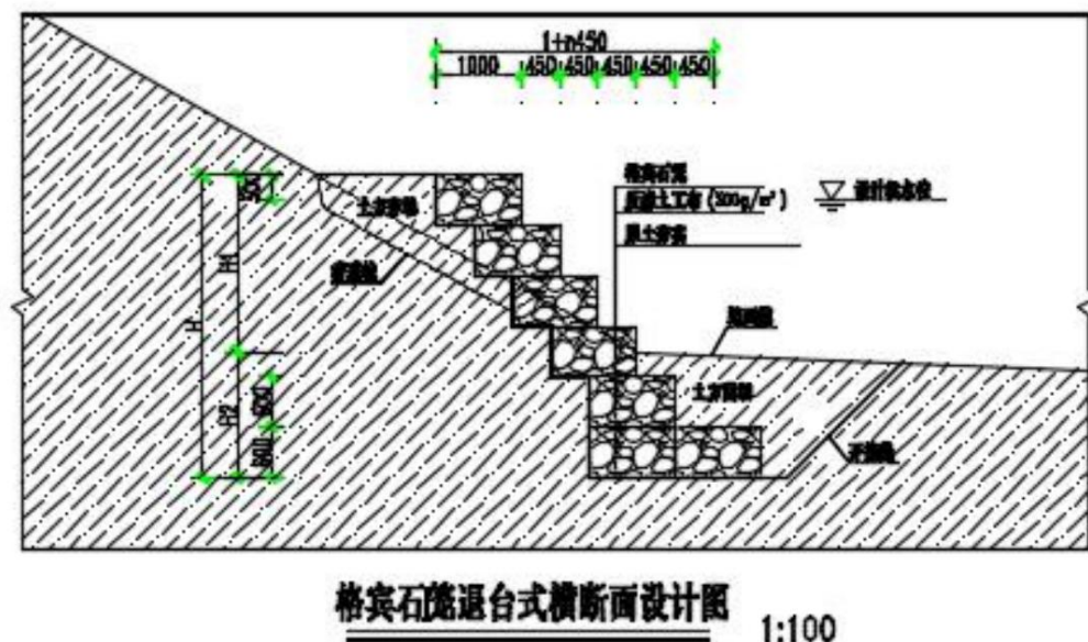
图 格宾石笼退台式结构
